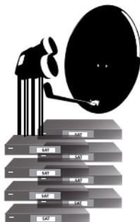
Verbinden Sie jeden Ausgang des Universal Octo LNBs mit jeweils einem SAT-Receiver.
