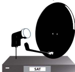
Verbinden Sie den Ausgang des Universal Single LNBs mit dem Eingang Ihres SAT-Receiver.
