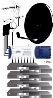
1. Verbinden Sie die 4 Ausgänge des Universal Quattro LNBs oder die 8 Ausgänge des Universal Octo LNBs mit den Eingängen des Multischalters.
